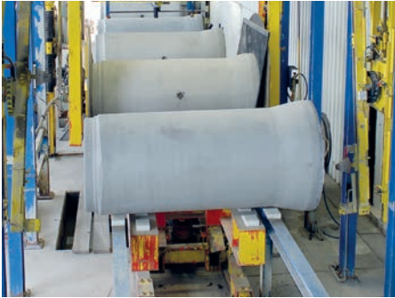
Bild 3.16: Serienprüfung des Spitzendurchmessers d_{sp} und Dichtheitsprüfung
