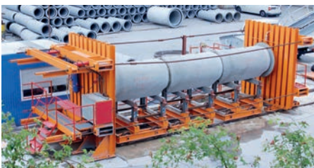
Bild 3.18: Strangprüfung von FBS-Rohren
