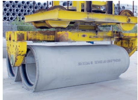
Bild 3.17: Automatische Kennzeichnung von FBS-Rohren
