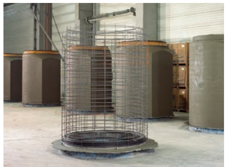
Bild 3.5: Fertiger Bewehrungskorb für FBS-Stahlbetonrohre
