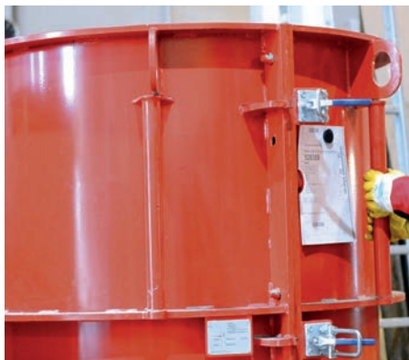
Bild 3.12: Form für die senkrechte Herstellung von in der Schalung erhärteten Rohren
