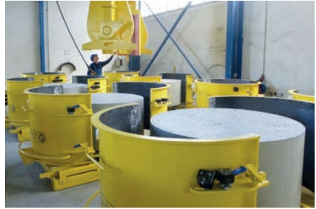
Bild 3.15: Herstellung von FBS-Schachtunterteilen mit monolithischem Gerinne
