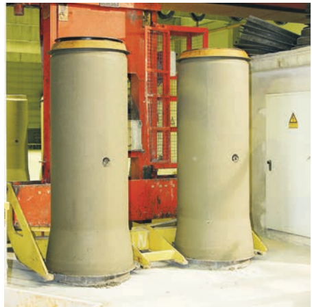
Bild 3.10: Rohre mit aufgesetzten Stützhauben
